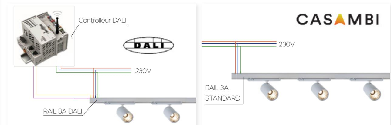
Le système **TRATO CONNECT'**, en intégrant l'intelligence au cœur des luminaires, réduit significativement le matériel nécessaire et le temps d'installation. Pour l'installateur électricien il n'y a pas de différence entre poser des luminaires standards ou des luminaires Connect'.
