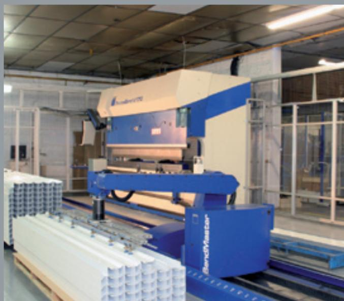
**Cellule de pliage automatisée** : Robot Bendmaster, pliage 8 axes, 170 t, longueur maxi de travail 4 m. Programmation off-line à partir de fichiers CAO 3D ou 2D.
