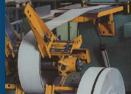
Poinçonnage - emboutissage de tôle fine à partir de coil.
