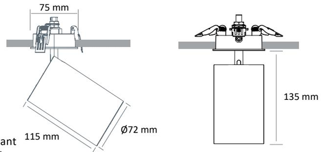
Un produit doté de la technologie ICOB est pourvu d'un mécanisme permettant le changement du module sur la douille GH36d-4 par simple rotation quart de tour.
