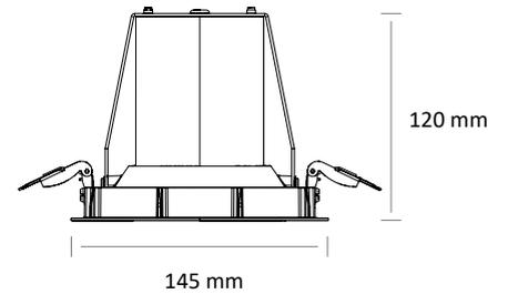
Un produit doté de la technologie ICOB est pourvu d'un mécanisme permettant le changement du module sur la douille GH36d-4 par simple rotation quart de tour.
