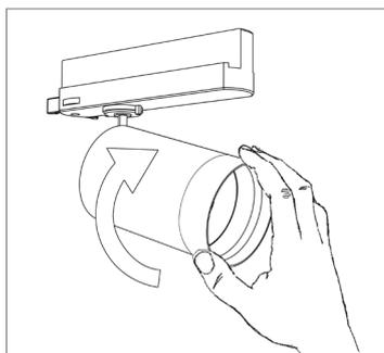
Faisceau réglable par une rotation de la bague avant du projecteur
