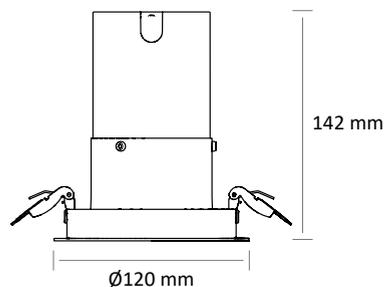
Un produit doté de la technologie ICOB est pourvu d'un mécanisme permettant le changement du module sur la douille GH36d-4 par simple rotation quart de tour.
